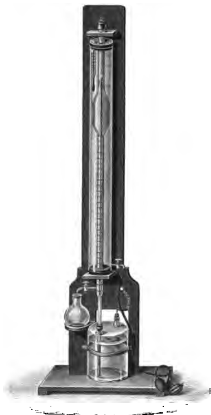
Fig. 38. — Appareil Seger et Cramer pour déterminer la densité du ciment.
